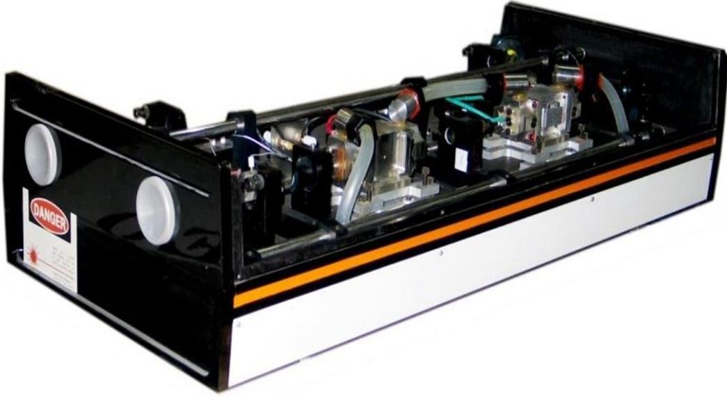
الشكل (2-4):جهاز ليزر Ti:sapphire المستخدم في البحث.
